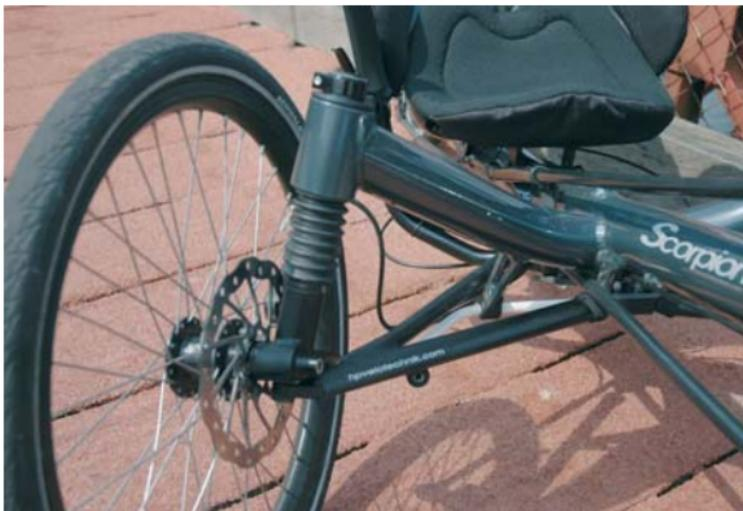
Om dit geheel stabiel te houden zit aan de onderzijde een driehoek-constructie die de boel op zijn plaats houdt. Door middel van verschillende veerelementen is de vering aan te passen aan het gewicht van de berijder. Een antirol-stang zorgt ervoor dat de trike in bochten niet teveel overhelt.
