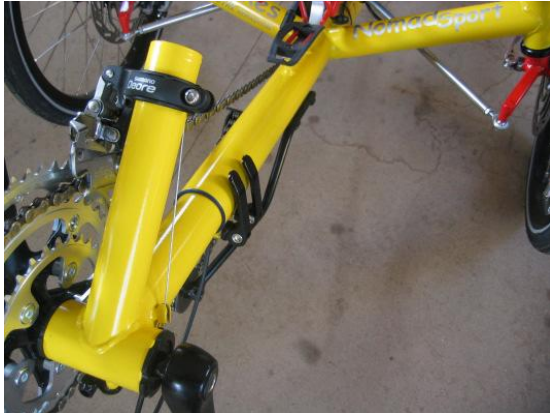
Figuur 1 Trapasbuis verstellen
